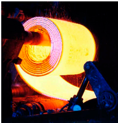
Coilbox im Warmbandwerk Bochum: Vor der Fertigstraße wird das Vorband aufgehaspelt, um Temperaturverluste bei empfindlichen Stahlqualitäten zu vermeiden.
